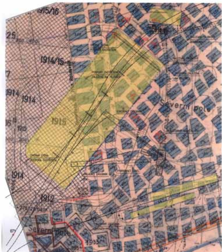
▲ Obr. 2. Výřez důlní mapy – komorové dobývání v dole Washington
